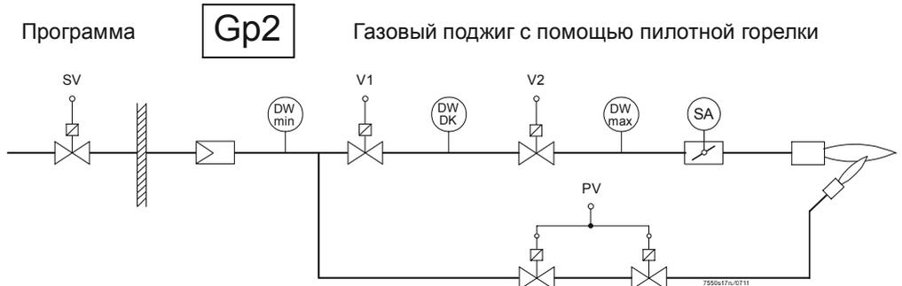
Программа управления топливным клапаном
