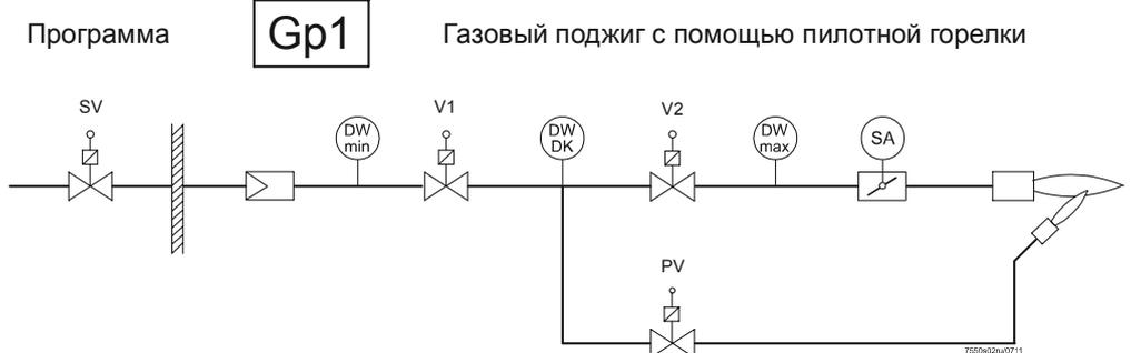
Розжиг при помощи дежурной горелки
