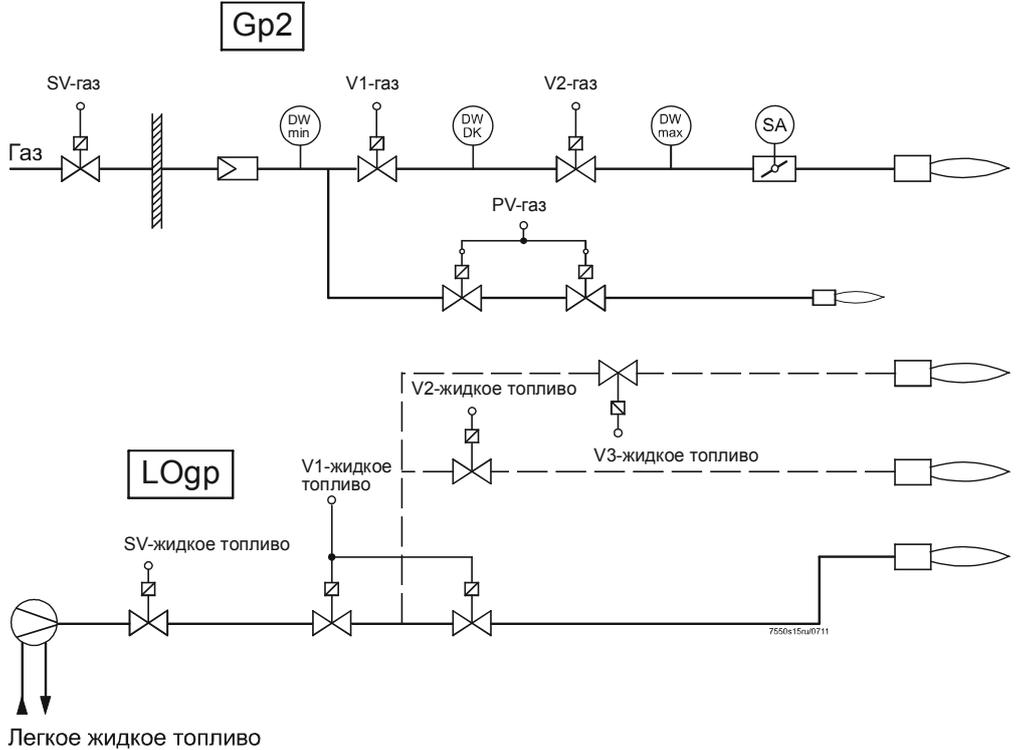
Программа управления топливным клапаном
